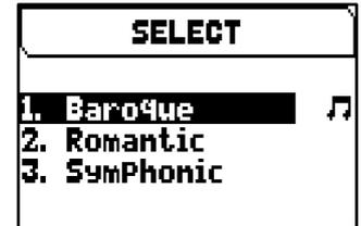
Verwenden Sie die Tasten [^] und [v], um den Cursor zu anderen Pipe Sets zu bewegen, und drücken Sie dann [MENU/ENTER], um die neue Auswahl zu bestätigen und nutzbar zu machen, oder drücken Sie [EXIT], um die Änderung zu vermeiden und den aktuell ausgewählten Rohrsatz zu verlassen.
