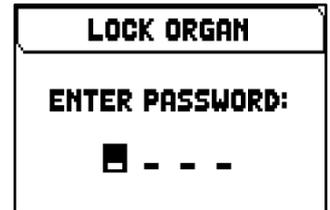
Um die Orgel zu entsperren, wählen Sie im Menü UTILITY das Feld UNLOCK ORGAN und geben Sie mit den oben beschriebenen Tasten das richtige Passwort ein. Wenn das Passwort korrekt ist, wird die Meldung "ORGAN UNLOCKED" angezeigt.
